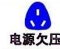
表示主机供电电源可能存在供电不足的现象，检查供电电压和电流。
